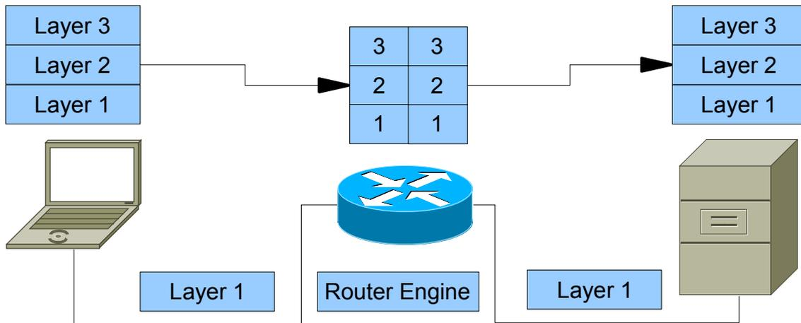
Der Client schickt ein IP-Paket zum Server. Der Client schaut, welche MAC-Adresse der Router hat. Der Router ist der Default-Gateway. Das IP-Paket wird mit der MAC-Adresse an den Router geschickt. Dieser leitet das Frame mit Hilfe der DST-MAC-Adresse an den Server weiter. Somit bekommt der Server das IP-Paket.
