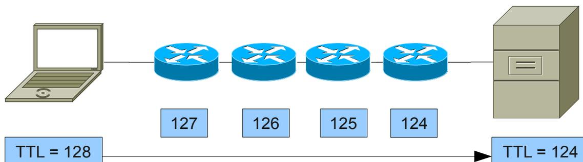
Das TTL beschreibt die Gültigkeitsdauer eines IP-Pakets. Das TTL-Feld ist standardmässig auf 128 eingestellt. Das TTL-Feld besagt, wie oft das Paket bei einem Hop (Router) vorbeikommen darf. Jeder Router verringert das Paket um 1. Wenn dann ein Router ein Paket erhält, von dem das TTL-Feld 0 ist, wirft er es weg.
